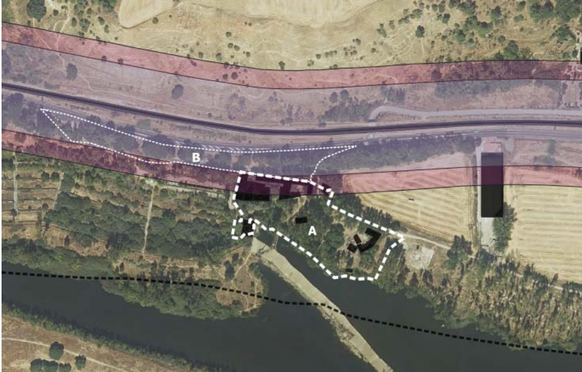
Esquema propio de zonificación de los límites de edificación (roda claro) y zona de protección (rosa más oscuro) de la legislación del sector ferroviario sobre ortofotografía y construcciones en la cartografía catastral Fuente: Propia sobre datos de DGCatastro y ortofotografía PNOA 2017.
