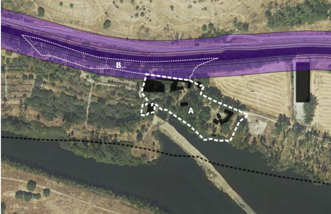
Esquema de las zonas de afección de las carreteras regionales y delimitación propia de la explanación de la carretera (franja oscura) y a partir de esta y a 30 m. la zona de afección de la carretera regional SA-804 sobre ortofotografía y construcciones en la cartografía catastral Fuente: Propia sobre datos de DGCatastro y ortofotografía PNOA 2017.
